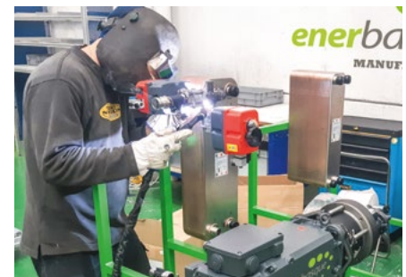
Bau des rORC-Prototyps bei Enerbasque
