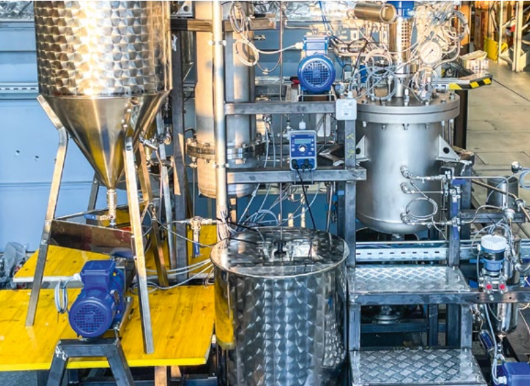
5 kW th kontinuierliches TCES-Reaktorsystem: Materialprüfgerät für verschiedene TCES-Paare, p_{\max} = 10 bars, \vartheta_{\max} = 200 °C.
