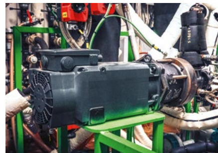
Twin Screw reversibel volumetrisk maskine – Kompressor/ Ekspander
