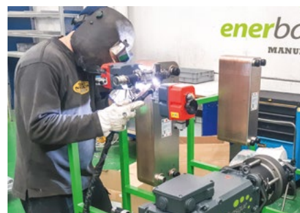
Konstruktion af rORC prototype på Enerbasque-faciliteten.
