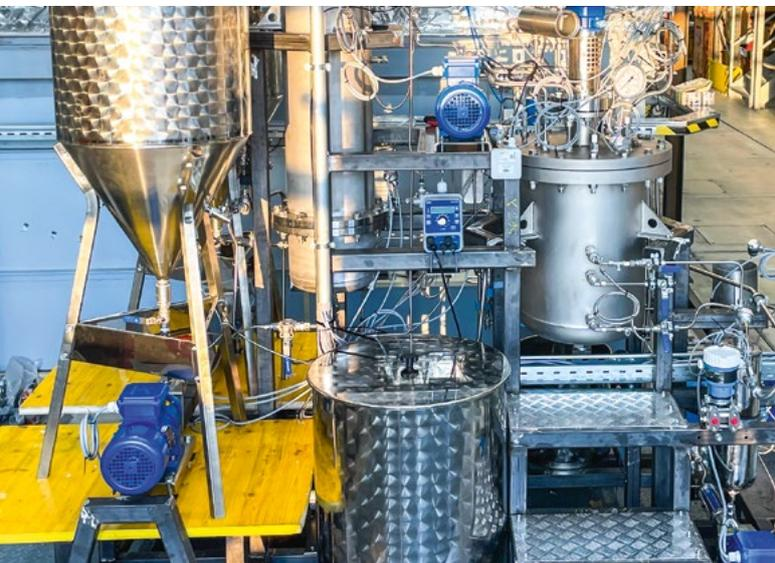
Sistema de reactor continuo TCES de 5 kW<sub>th</sub>. Dispositivo de prueba de materiales para diferentes pares de TCES, p<sub>max</sub> = 10 bars, θ<sub>max</sub> = 200 °C.
